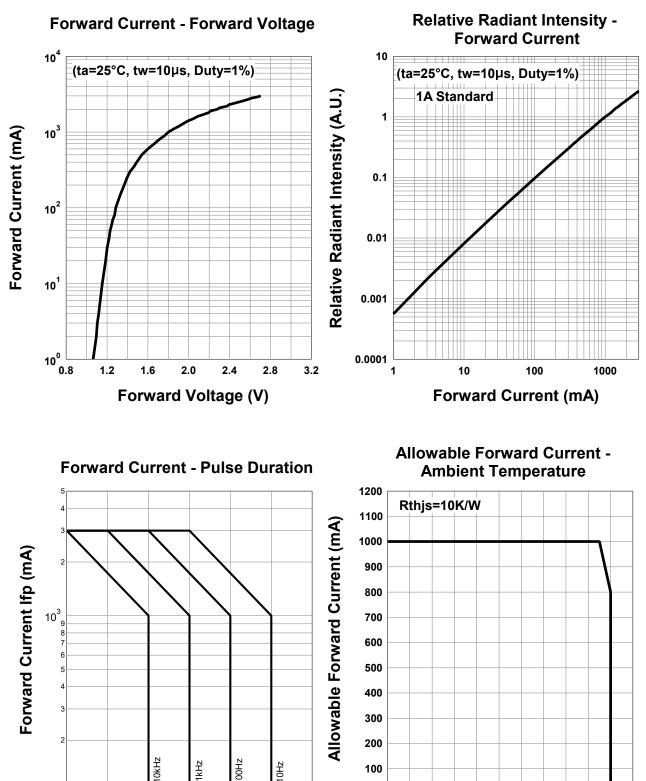
100Hz 1kHz 10Hz 100 0 0 20 100 40 60 80 10<sup>4</sup> 10<sup>5</sup> 10<sup>6</sup> Ambient Temperature (°C) Duration tw (µs)
